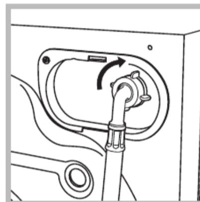
2. Collegare il tubo di alimentazione alla lavabiancheria avvitandolo all'apposita presa d'acqua, nella parte posteriore in alto a destra (vedi figura).
