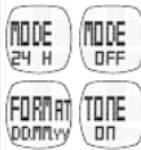
Para alterar o valor, ou para o aumentar ou reduzir, prima a tecla Toggle/+ ou a tecla Toggle/-. Para confirmar o valor, prima a tecla principal. Para interromper o ajuste, prima a tecla STOP. Pode utilizar este procedimento para os quatro pontos de menu.
