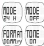
Um den Wert zu ändern bzw. zu erhöhen oder zu reduzieren, drücken Sie die Toggle/+ oder die Toggle/- Tasten. Um den Wert zu bestätigen, drücken Sie die Toptaste. Um die Einstellung abzubrechen, drücken Sie die STOP Tasten. Dieses Vorgehen können Sie bei allen vier Menüpunkten anwenden.
