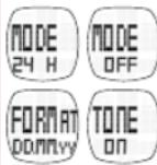
Para modificar, aumentar o reducir un valor presione la tecla Toggle/+ o Toggle/-. Para confirmar el valor presione la tecla superior. Para cancelar el ajuste presione la tecla STOP. Este procedimiento puede ser utilizado en todos los cuatro puntos del menú.
